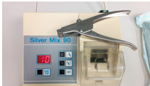
Slika 1.11 Miješalica i „pištolj“ za kapsulirane materijale. Miješalica podešena na 10 sekundi.
